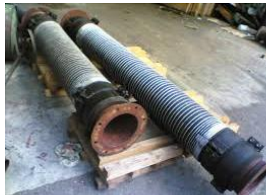
Рисунок 3 – Гумові рукава високого тиску, які мають додаткове посилення металевим дротом
