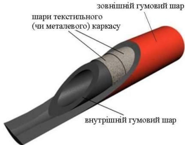
Рисунок 2 – Схематичне зображення внутрішньої будови напірних гумових шлангів
