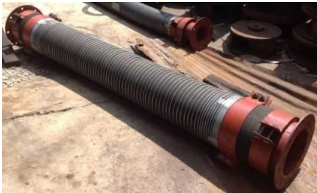
Рисунок 3 – Гумові рукава високого тиску, які мають додаткове посилення металевим дротом
