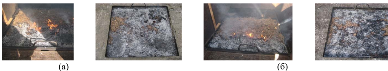
Рисунок 5 – Проходження полум'я крізь загороджувальну смугу створену нанесенням води: (а) – під дією потоку повітря; (б) – без потоку повітря.
