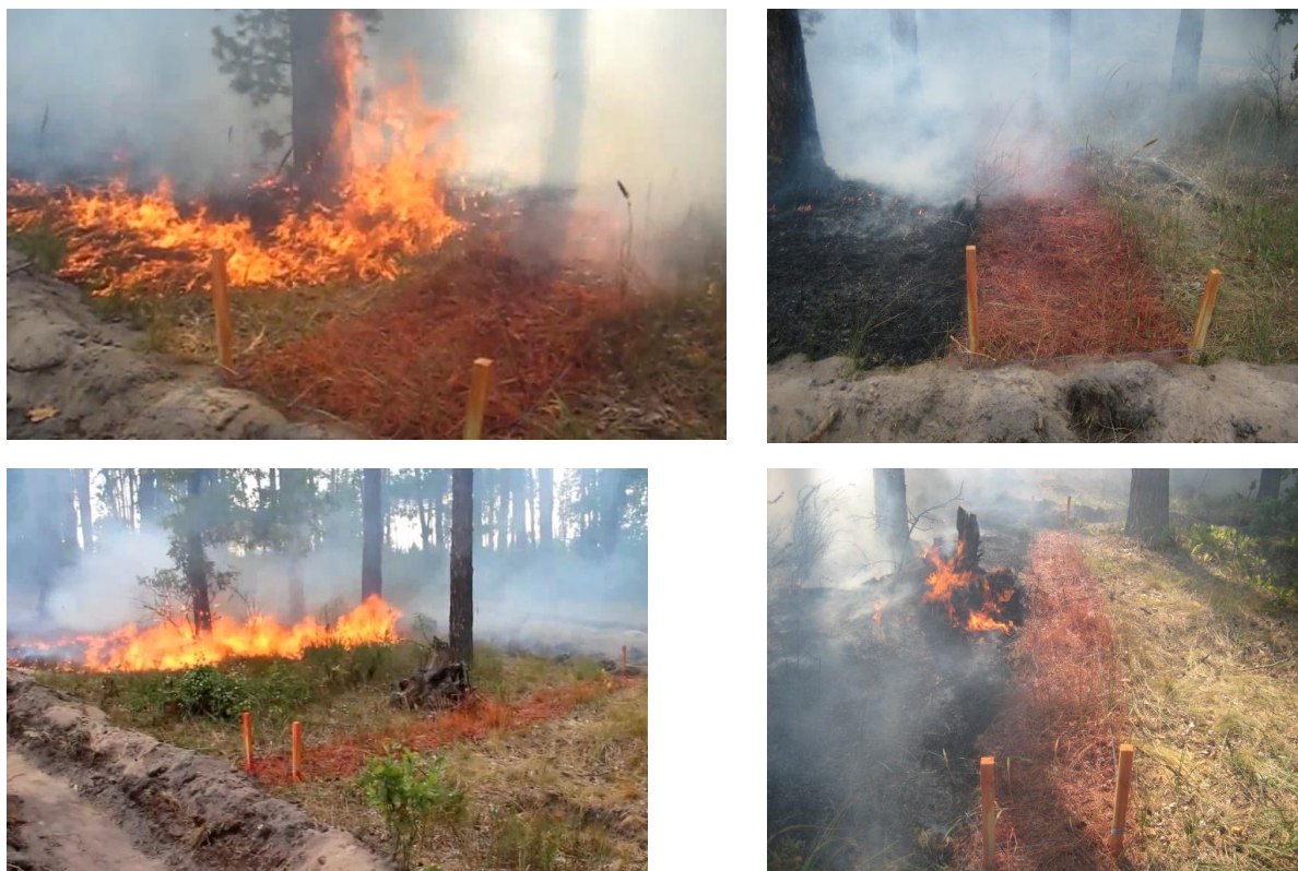
Рисунок 5 – Визначення ефективності загороджувальних смуг у припиненні горіння лісової підстилки.
