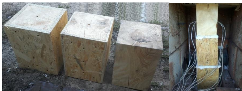
Рисунок 1 – Фрагменти дерев'яних колон для проведення вогневих випробувань
