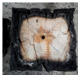
Рисунок 2 – Схема вимірювання обуглення перерізу фрагменту дерев'яної колони
