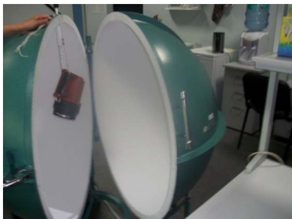
Рисунок 5 – Загальний вигляд розміщення ліхтаря всередині фотометричної інтегруючої сфери
