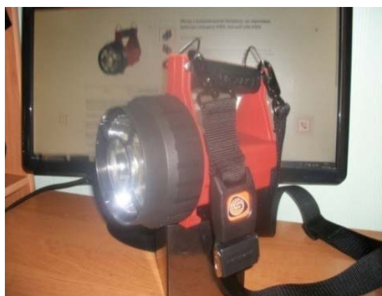
Рисунок 3 - Загальний вигляд групового пожежного ліхтаря VULCAN® LED
