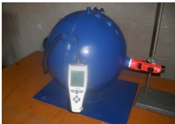
Рисунок 4 - Загальний вигляд розміщення ліхтаря зовні фотометричної інтегруючої сфери
