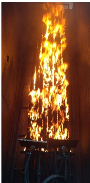
Рисунок 5 – Зовнішній вигляд кабелів на 30-ій хвилині випробування за ДСТУ EN 60332-3-22 [20]
