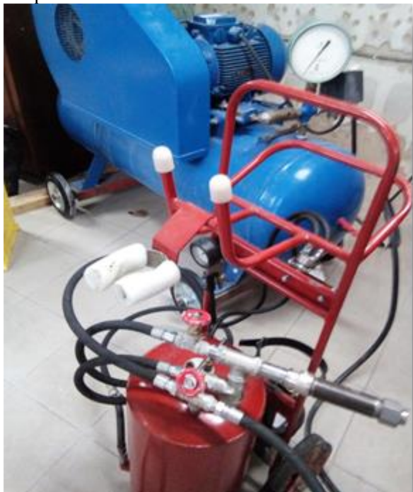
Рисунок 1 – Експериментальна система пожежогасіння компресійною піною
