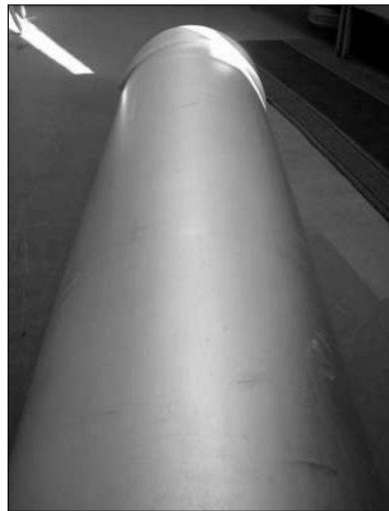
Рис. 2. Триметаллический магистральный трубопровод
