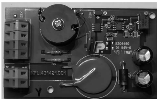
Рис. 4. Джерело живлення на друкованій платі
