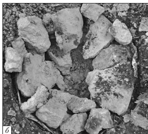
Рис. 5. Ґрунт до і після руйнування одним розрядом: а – блок до обробки, б – блок після обробки
