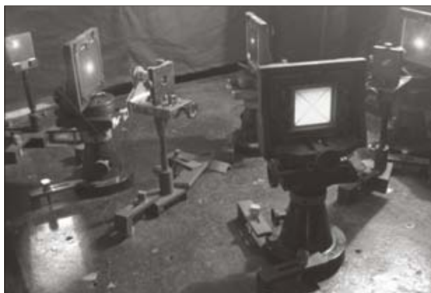
Рис. 2. Оптична схема запису інтерференційної картини на чипах для ППР-рефрактометра
