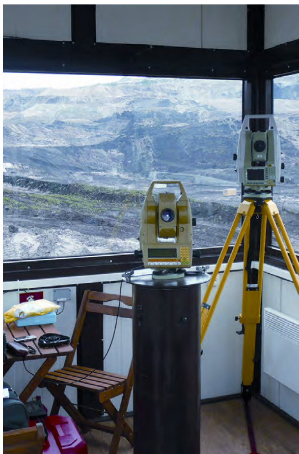
Rys. 3. Widok wnętrza kontenera pomiarowego z dwiema zautomatyzowanymi stacjami tachymetrycznymi (źródło: Leica Geosystems)
