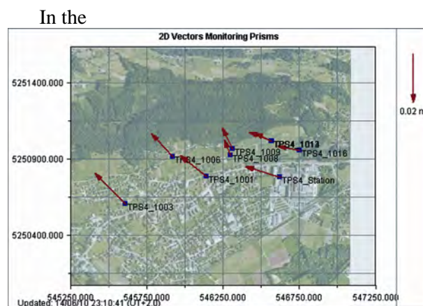
Rys. 5. Widok okna dialogowego aplikacji GeoMoS Web prezentującego wyniki pomiaru przemieszczeń (Leica Geosystems)
