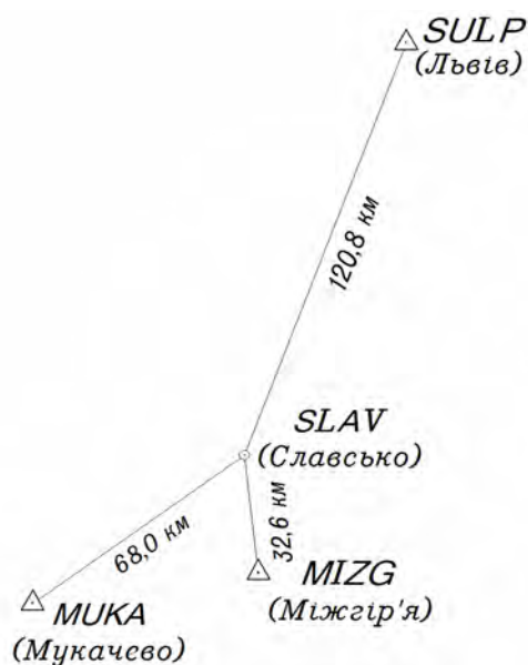
Рис. 3. Схема розташування пункту SLAV та референцних станцій
