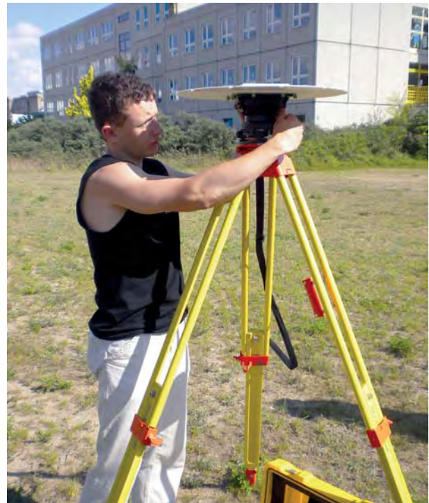
Встановлення обладнання для GPS-знімання
