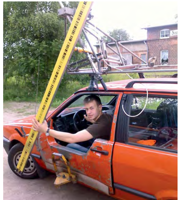
Студент Євген Лавришко виконує моторизоване нівелювання
