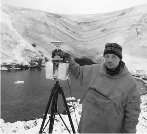
Рис. 4. Визначення координат марки та сканера методом ГНСС
