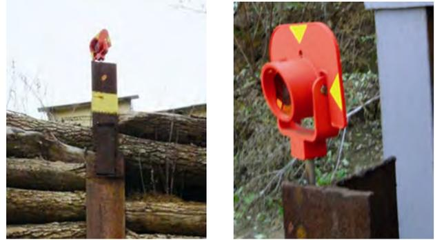
Рис. 8. Вид закрепленных призмных отражателей
