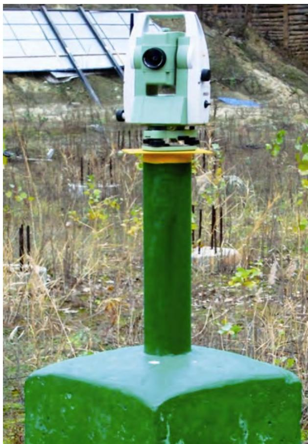
Рис. 3. Пилон с установленным прибором
