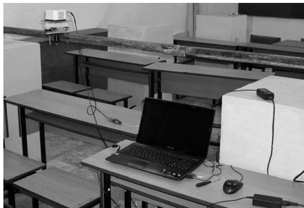
Рис. 3. Інклінометр встановлений на рамі та під'єднаний до комп'ютера. В загальному вигляді конструкція наведена на рис. 4
