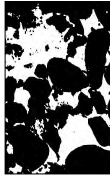
Рис. 1. РЕМ-мікрофотографія зразка ґрунту (режим катодолумінесценції Мкрат = 80)
