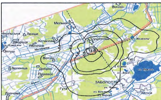
Рис. 1. Передбачуване зниження рівня ґрунтових вод під час експлуатації II черги родовища "Хотиславське" на період 2014–2040 рр. без застосування протифільтраційного захисту: а – 2014 р.; б – 2019 р.; в – 2024 р.; г – 2040 р.
