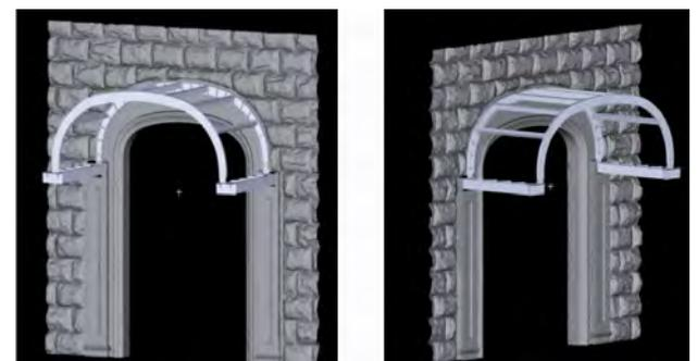
Рис. 11. 3D модель фасада і козырька будівлі
