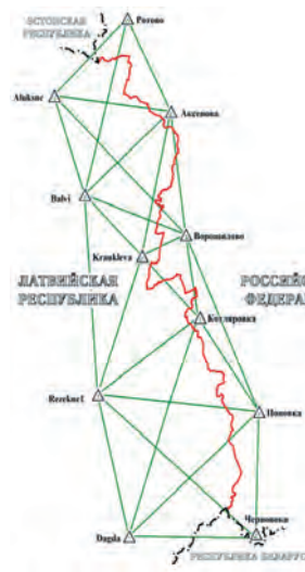
Рис. 6. Каркасная геодезическая сеть демаркации государственной российско-латвийской границы
