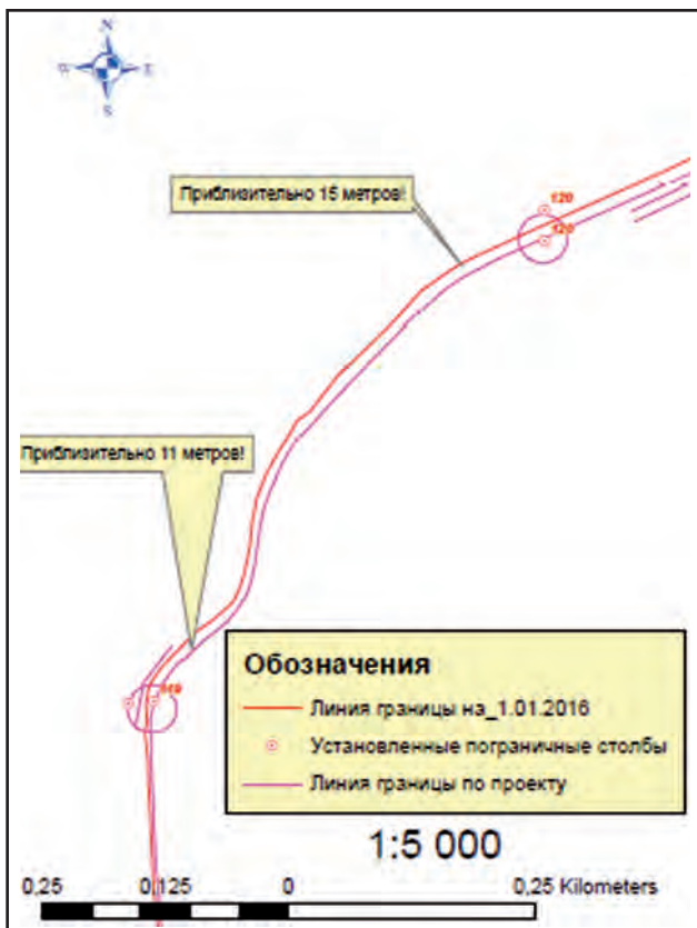
Рис. 10. Схема различий в отображении линии границы до и после создания общего геодезического обоснования
