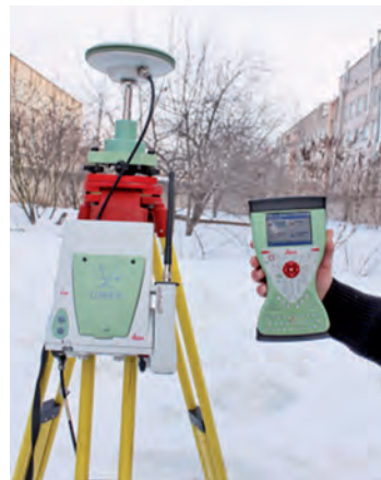
Рис. 5. Внешний вид спутниковой геодезической аппаратуры (слева СГА Leica Geosystem 1200GG+ в сборе для полевых измерений на штативе, справа – Topcon GB 500)
