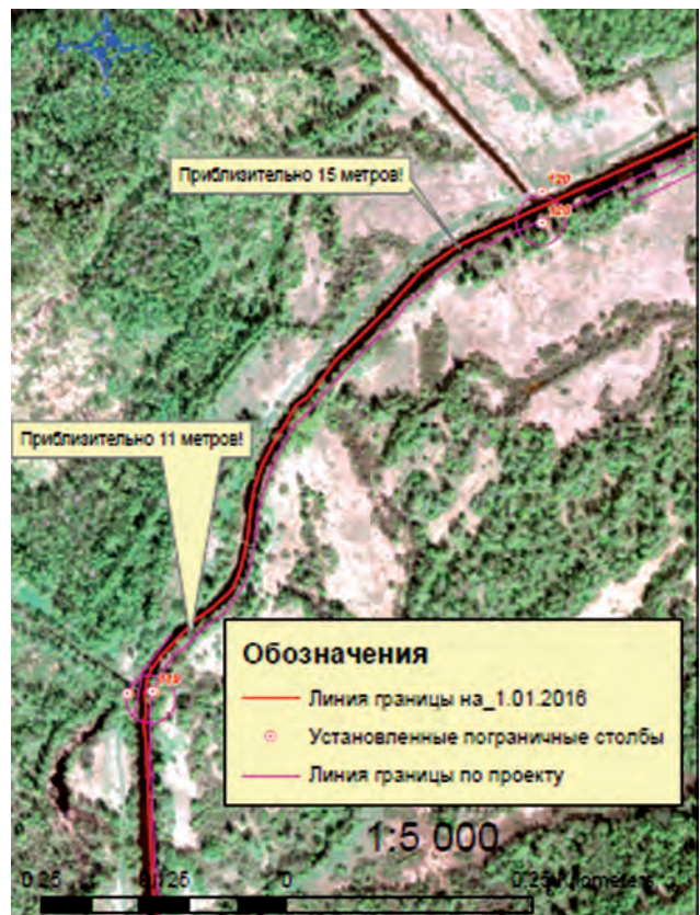
Рис. 11. Схема различий в нанесении линии границы до и после создания общего геодезического обоснования на обновленное ортофото и мест геодезически определенных пограничных знаков
