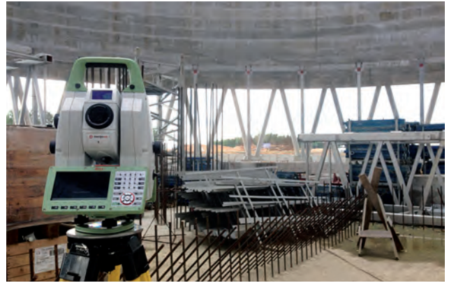
Рис. 8. Моніторинг градирні за допомогою мультистації
