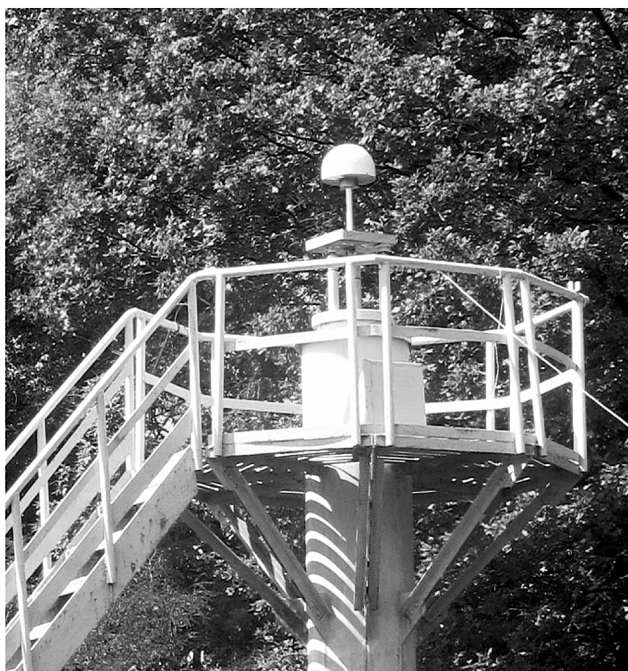
Рис. 1. Один из реперных пунктов полигона “Липцы” с антенной “choke-ring”
