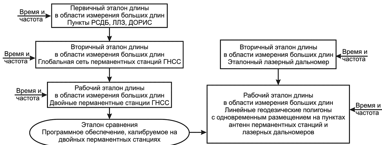
Рис. 7. Фрагмент возможной поверочной схемы в области больших длин (малых расстояний), основанной не на национальных, а на международных эталонах и средствах измерений
