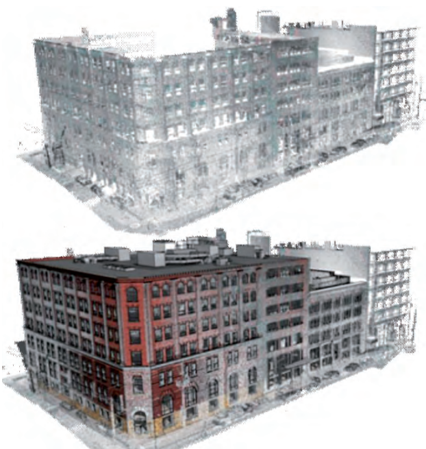
Рис. 2. Построение модели по облаку точек
