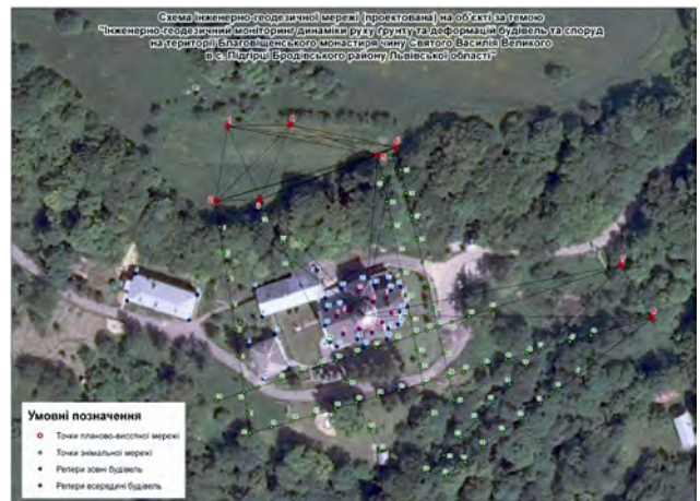
Рис. 7. Схема інженерно-геодезичної мережі на території Підгорецького монастиря
