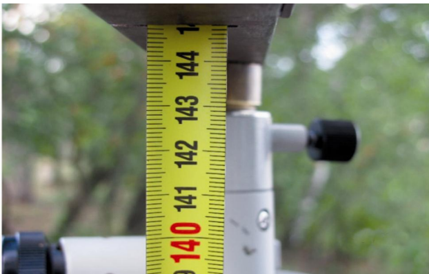
Рис. 3. Вимірювання висоти приладу методом фотофіксації (відлік 1448,0 мм)
