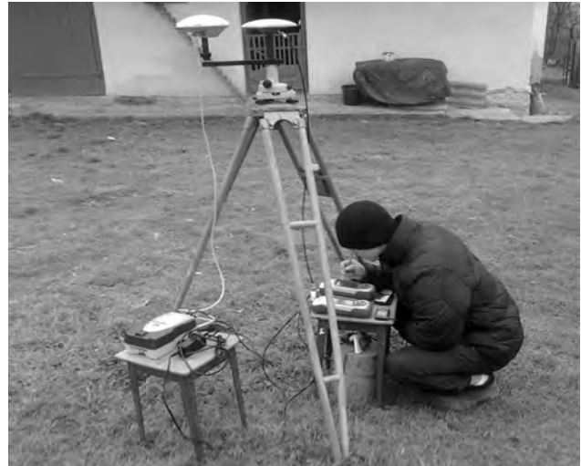
Рис. 4. Робота з GNSS-приймачами у режимі RTK
