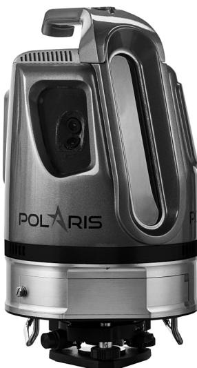
*Рис. 6. Наземна сканувальна система Polaris TLS*
