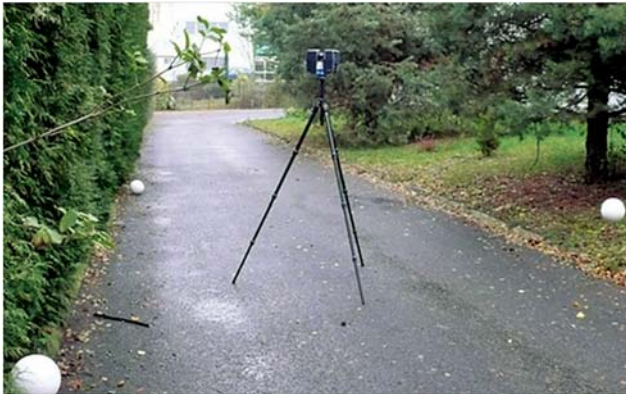
Рис. 1. Розміщення (білих) кульових опознаків для з'єднання хмари точок під час наземного лазерного сканування (НДГТКІ)
