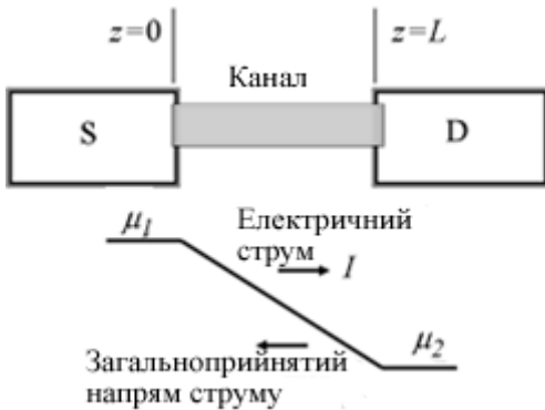
Рис. A1.2. До розв'язування системи рівнянь (A1.1) і (A1.10) з крайовими умовами (A1.11). Як і в [1], завжди використовується напрям струму від витoku (S) до стоку (D), тотожний напрямові руху електронів і протилежний до загальноприйнятого в силу історичних причин напрямку струму від «плюса» до «мінуса».
