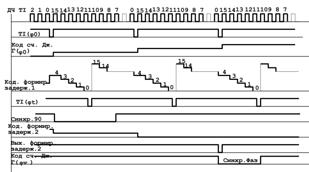
Рис. 6. Временные диаграммы, поясняющие работу двухфазного генератора (1).
