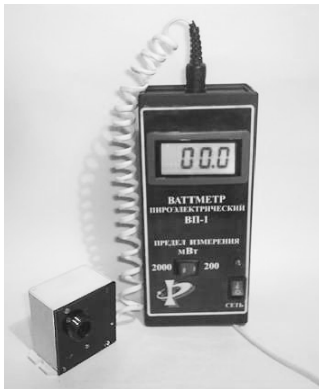
Рис. 1. Зовнішній вигляд піроелектричного вимірювача потужності випромінювання ВП-1.
