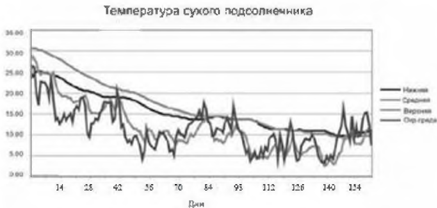
Рис. 2 Эволюция температур окружающей среды и зерна (ср. 24 ч) в течение периода проведения проб у подсолнечника со средней влажностью 8,4%
