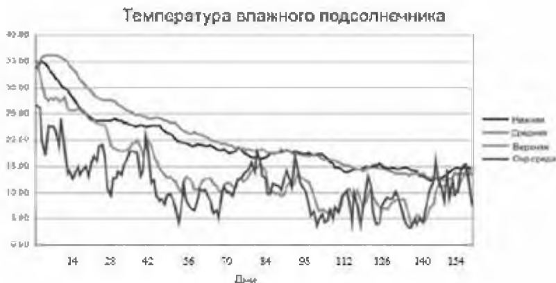
Рис. 3 Эволюция температур среды и зерна (ср. 24 ч) в течение периода проведения проб у подсолнечника со средней влажностью 16,4%
