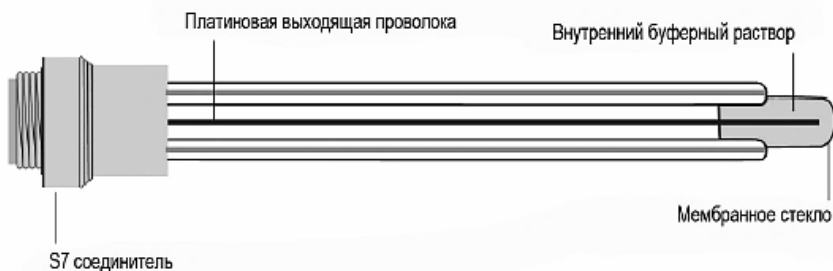
Рис. 2. Схема pH -электрода с чувствительной мембраной
