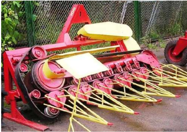
Рис. 3 – Льонобралка ТЛН-3,8 оснащена бральним апаратом з п'ятьма бральними рівчачками
