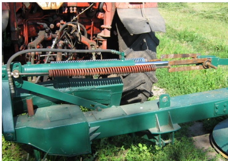
Рис. 2 – Модернізована система виважування різального блока косарки розташованого над центром диска. Зусилля підйому як зовнішнього, так і внутрішнього диска збільшується із збільшенням висоти підйому.
