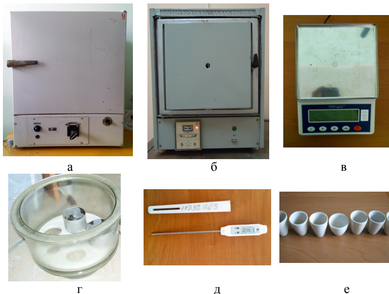
Рис 2 – Прилади та обладнання, що використовувалось під час досліджень: а – сушильна електрошафа СНОЛ – 3,5.3,5.3,5/3 ИЗ; б – муфельна електроніч СНОЛ – 1,6.2,5.1/11 ИЗ; в – електронні ваги ТЛВ-0,5; г – ексикатор із бюксами; д – термометр-щуп електронний TFA 301018; е – фарфорові бюкси
