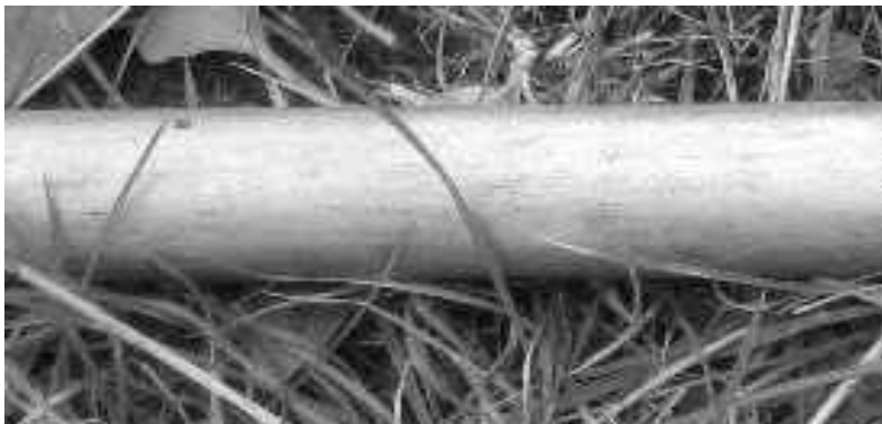
Рис. 1 – Фото сапропелерозвідувального бура: 1 – пробовідбірний човник; 2 – подовжувальні штанги
