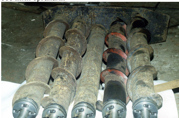
Рис. 2 – Гвинтовий циліндричний сепаратор зі зміщеними осями обертання
