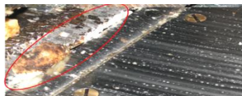
Рис. 6 – Неправильний зазор між різальною кромкою ножа і контрольною планкою у дисковій бурякорізці «PUTSCH»
