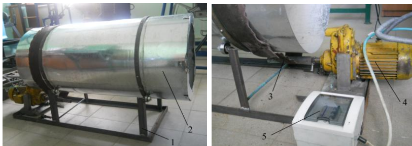
Рис. 2 – Фото лабораторної установки: 1 – рама; 2 - обкочуючий барабан; 3 – пасова передача; 4 – мотор-редуктор; 5 – блок керування
