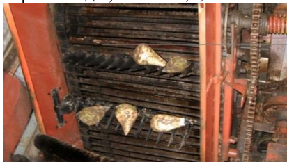
Рис. 1 - Загальний вигляд повздовжнього скребкового транспортера-сепаратора коренезбиральної машини КС-6Б з адаптованим механізмом повертання скребків
