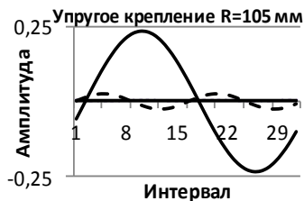
Рис 3 – Торцевое биение диска пилы при упругом ее закреплении на радиусе измерения 105 мм
