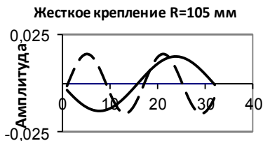
Рис 7 – Торцевое биение диска пилы при жестком ее закреплении на радиусе измерения 105 мм
