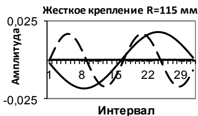
Рис 6 – Торцевое биение диска пилы при жестком ее закреплении на радиусе измерения 115 мм
