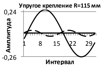
Рис 2 – Торцевое биение диска пилы при упругом ее закреплении на радиусе измерения 115 мм
