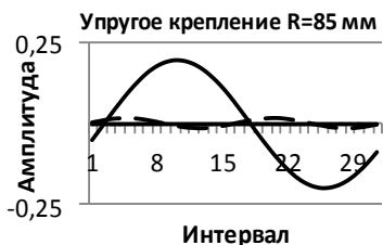
Рис 4 – Торцевое биение диска пилы при упругом ее закреплении на радиусе измерения 85 мм
