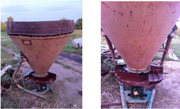
Рис. 5 – Навішування розробленого відцентрового робочого органа на машину МБУ–0,5
