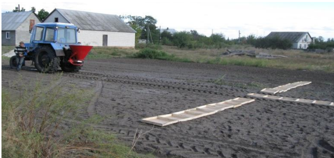
Рис. 8 – Полеві дослідження машини Garmet-500 під час руху, відхиленому від поступального, з розробленим робочим органом
