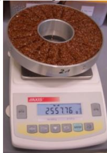
Рис. 3 – Зважування досліджуваного матеріалу на електронній вазі Axis
