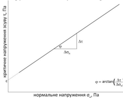
Рис. 5 – Залежність середніх критичних напружень зсуву \tau від нормального напруження (тиску) \sigma_n
