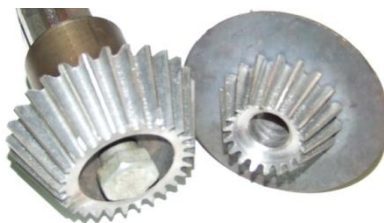
Рис.9 – Пара зубчастих конічних формуютьорюючих інструментів
