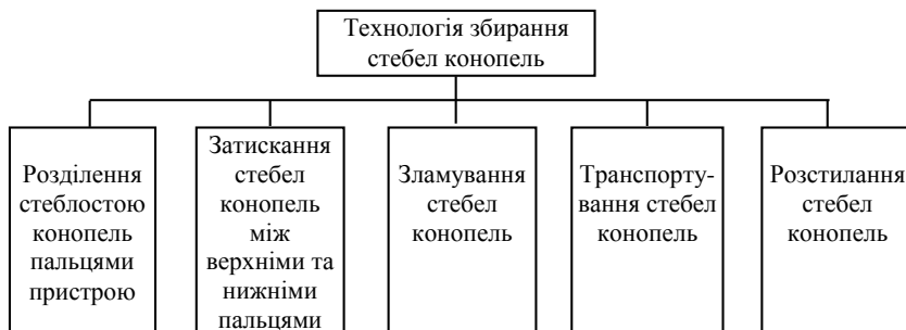
Рис. 2 – Функціональна схема технологічного процесу збирання стебел конопель
