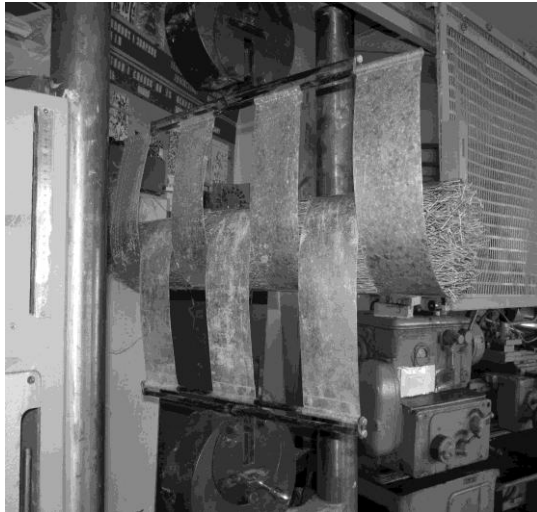
Рис. 2 – Стискання снопа стеблової стрічки льонотрести у пристосуванні на універсальній розривній машині УММ-5
