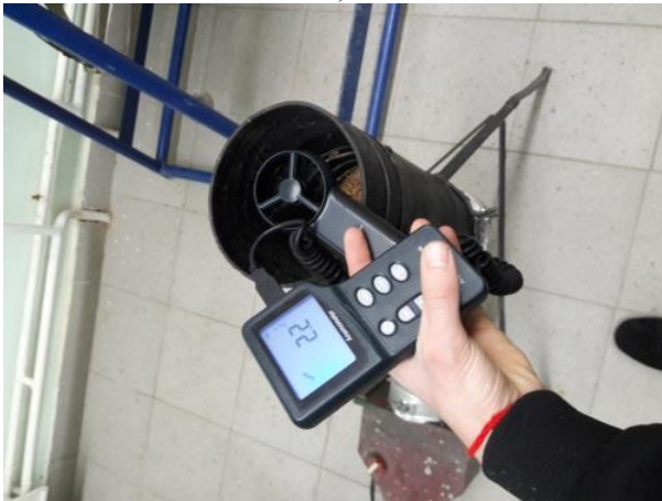
Рис.1 - Лабораторна установка для дослідження вентиляції шару сипкого матеріалу: а) – загальний вигляд; б) – вимірювання швидкості повітряного потоку
