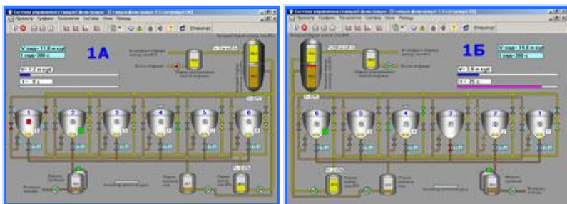
Рис. 1 – Система керування процесами фільтрування на Гнідавському цукровому заводі
