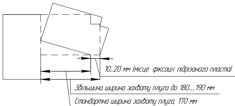
Рис.2 – Схема підрізаного пласта ґрунту модернізованим міні агрегатом
